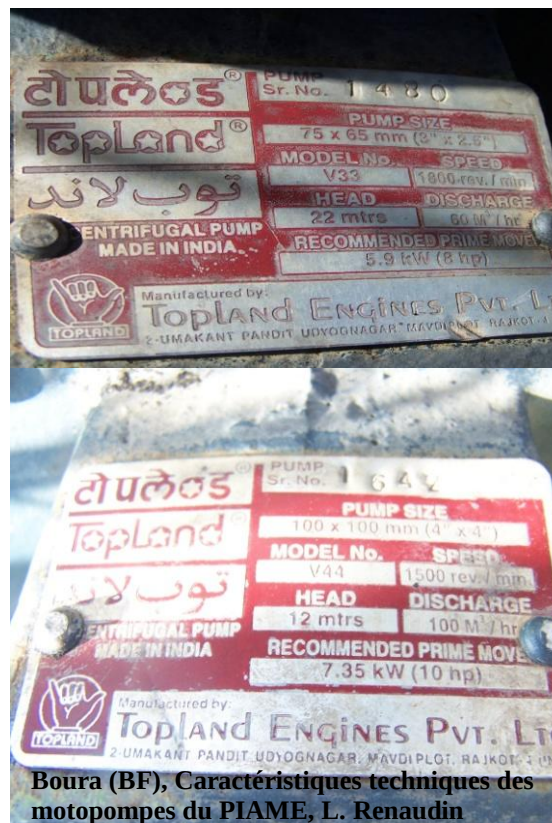
(D) : Caractéristiques techniques des deux motopompes couplées
