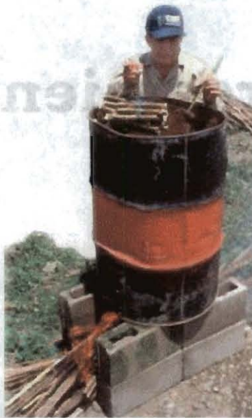
Figura 6. Tratamiento térmico de estacas
