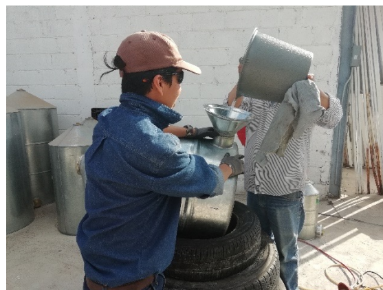
■ Figura 5. Revisión de la hermeticidad de bolsas plásticas (izquierda) y de un silo metálico hermético con la prueba de agua (derecha) en la instalación de la plataforma Texcoco, Estado de México, 2019.
