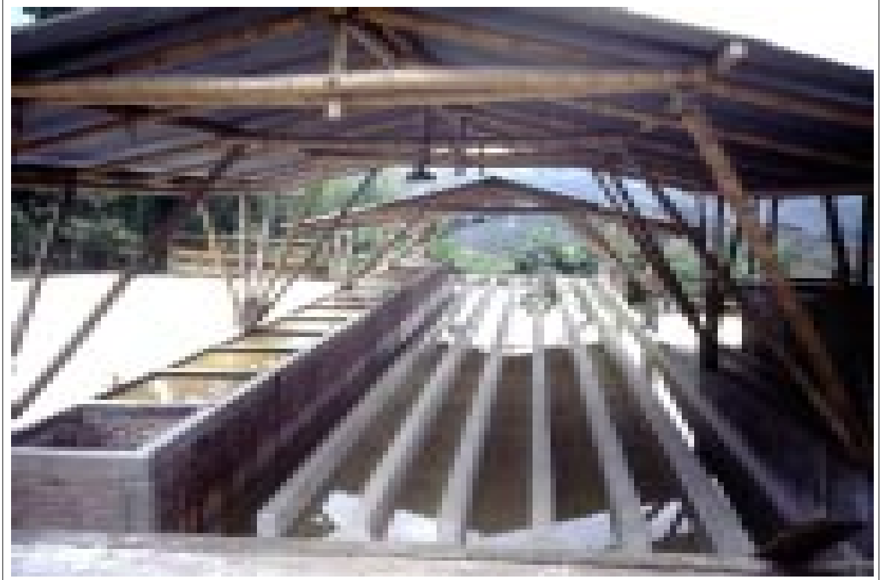
Foto 5. Sistema de siete canales para la sedimentación del almidón a partir de la lechada de yuca.
