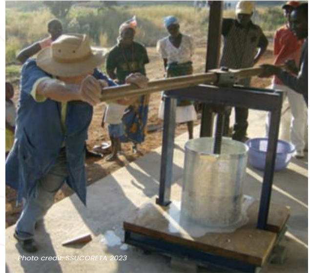
Picha Na. 8. Chombo cha kukamua muhogo kinachotumia nguvu ya binadamu ili kuondoa maji na sumu kwenye muhogo uliosindikwa
