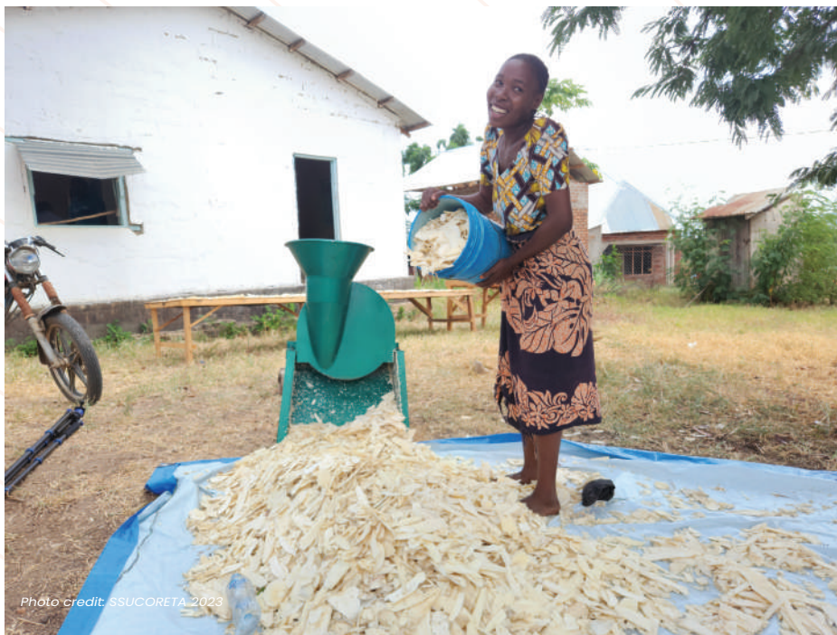
Picha Na. 6. Aina ya mashine ya kusindika muhogo ya kukereza inayotumia mafuta aina ya dizeli
