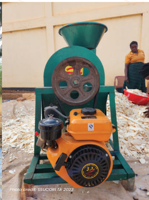
Picha Na. 6. Aina ya mashine ya kusindika muhogo ya kukereza inayotumia mafuta aina ya dizeli
