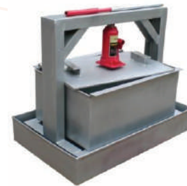
Picha Na. 9. Picha ya kifaa cha kukamua muhogo inayotumia jeki ya gari ili kuondoa maji na sumu kwenye muhogo uliosindikwa
