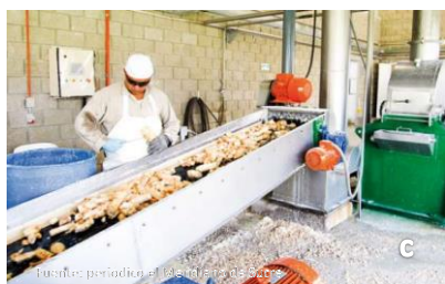
Figura 2 (a) Cosecha de un ensayo de cosechas extendidas como parte de una investigación relacionada 1 ; (b) pesado de la yuca en Almidones de Sucre (AdS) para estimar el contenido de almidón; (c) picado de la yuca como proceso inicial en la planta de AdS.
