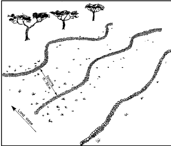
Fig. 1.5- Barreira trapezoidal (arranjo de campo), (Critchley e Siegert, 1991)
