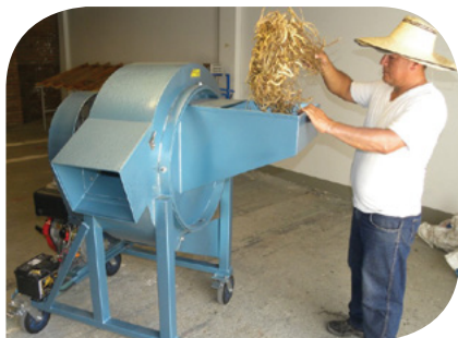
◀ Imagen 18. Trilla de fríjol asistido por trilladora mecánica.
