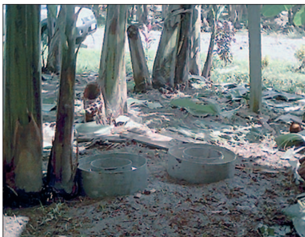
Figura 1. Prueba de infiltración básica en la banda y la entrecalle de una plantación de banano con la metodología de doble anillos.
