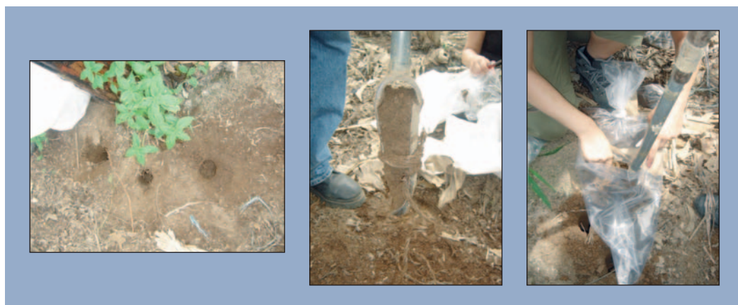
Figura 6. Proceso de toma de muestra de biológicos: a) agujero, b) toma de muestra con el barreno holandés, c) identificación de la muestra.
