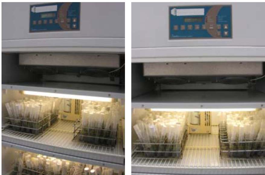
Figura 22. Cámara de termoterapia para realizar los tratamientos de limpieza de virus in vitro .
