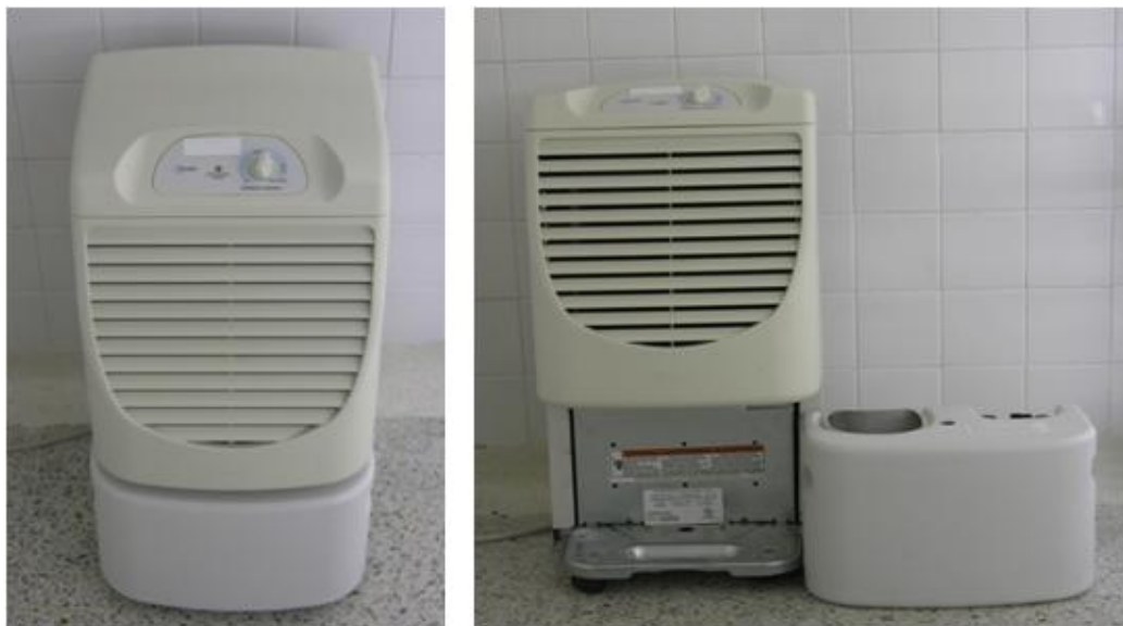
Figura 10. Deshumificador utilizado para el control de humedad relativa en los cuartos de crecimiento y conservación.
