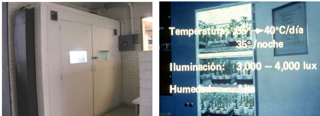
Figura 16. Cámara y condiciones requeridas para el proceso de termoterapia a las estacas.
