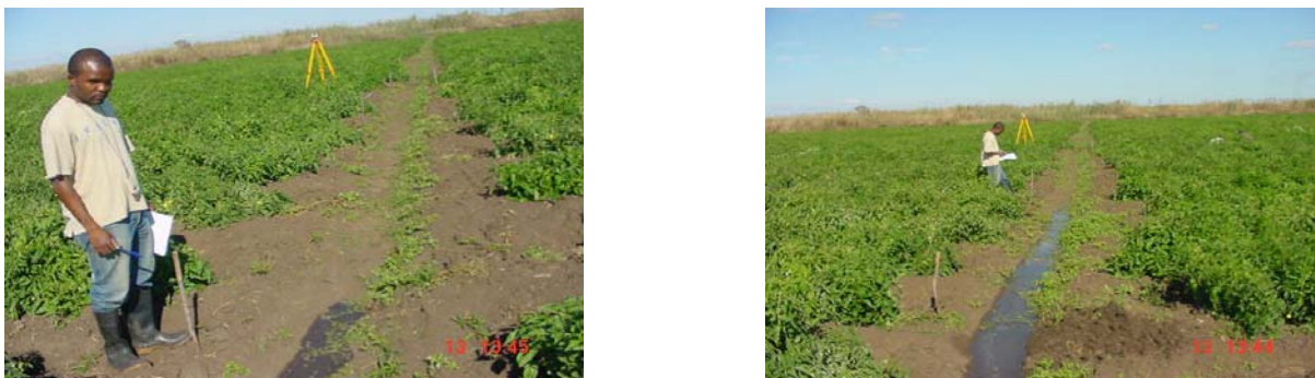
Figura 12. Determinação das frentes de avanço nos canais de cabeceira e nos sulcos
