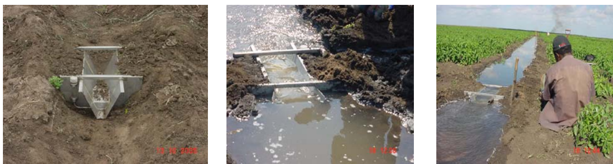
Figura 10. Determinação de volume de água nos canais de cabeceira e nos sulcos usando flume.
