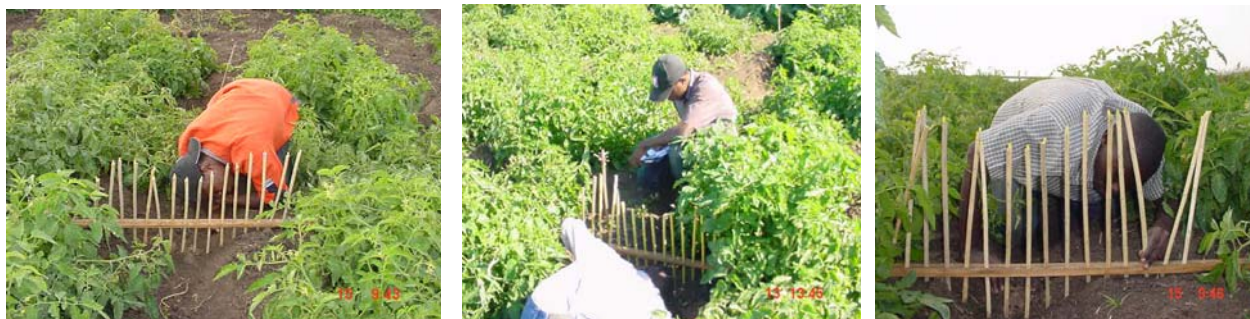
Figura 13. Determinação da secção transversal dos canais de cabeceira e dos sulcos
