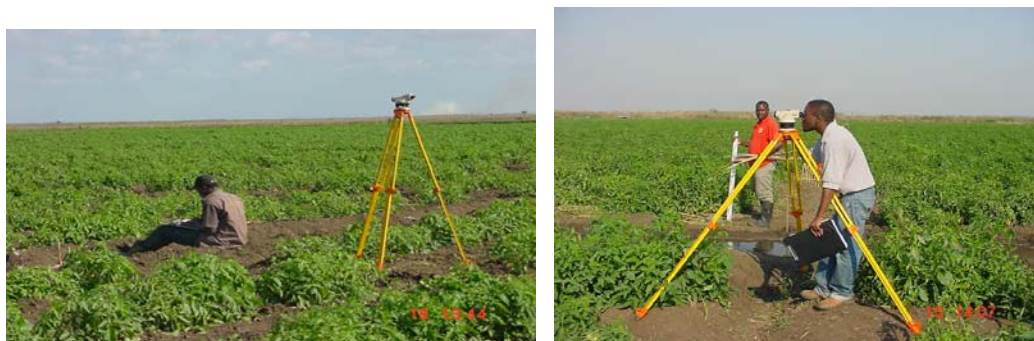
Figura 11. Levantamento topográfico dos canais de cabeceira, dos sulcos e do campo
